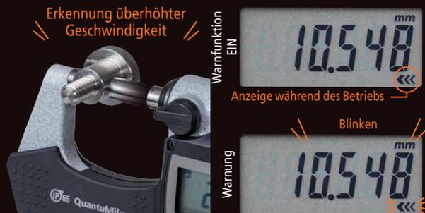
Die Warnfunktion für Annäherungsgeschwindigkeit erkennt ein zu hartes Anfahren von Werkstücken aufgrund überhöhter Vorschubgeschwindigkeit. Dadurch können selbst unerfahrene Bediener stabile und genaue Messergebnisse erzielen.
