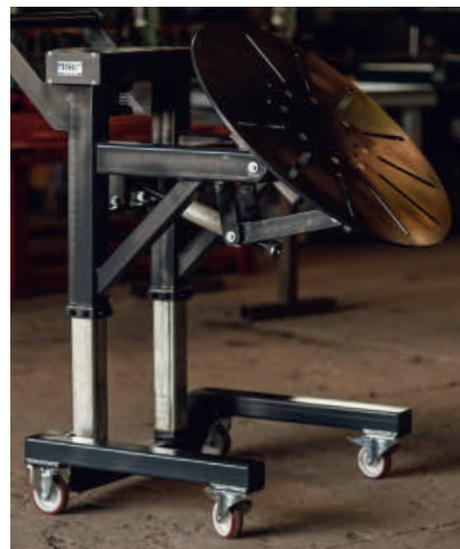
flexible Kugellagerrollen mit Feststellbremse
